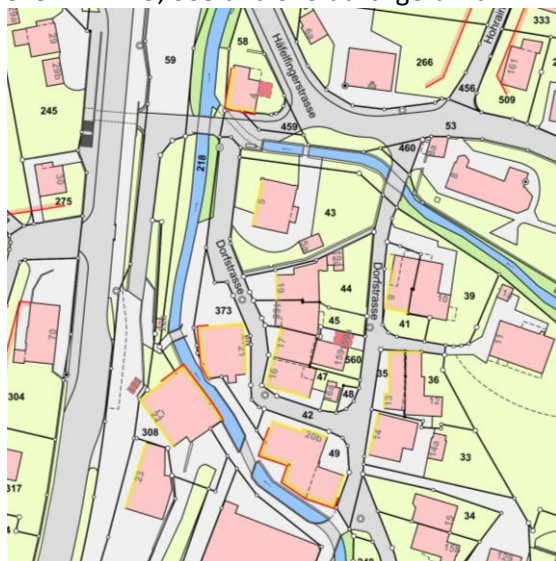
Abb. 41: Bestehende «verbindliche Baufluchten» (gelb) die vom minimalen Gewässerraum überlagert werden (rot) (Quelle: GeoView BL, eigene Darstellung)
